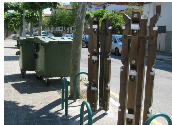
↓ Figura 117. Estruturas de soporte de pequenos contedores selectivos para sistemas porta a porta.
